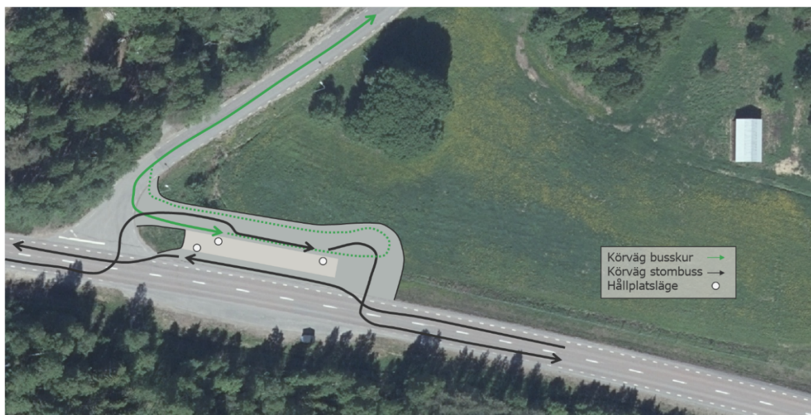
Figur 15: Förslag på utformning av framtida hållplatslösning för stomtrafik på väg 95 samt angörande autonom skyttel.
